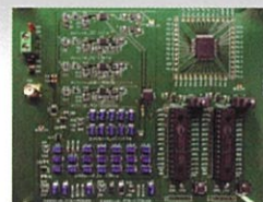
可変アナログ回路 (SFE回路) 試作検証用ボード
