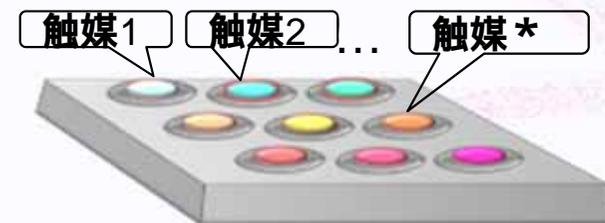
選択燃焼層の触媒材料を変更する事により複数ガス種を検知
