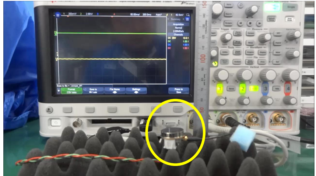
スポンジ落下で微小インパルス加振
