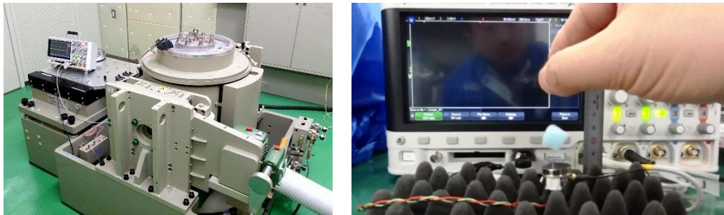
図 3-③-(2)-3.6 インパルス型エネルギーハーベスタ（段付き）加振試験
