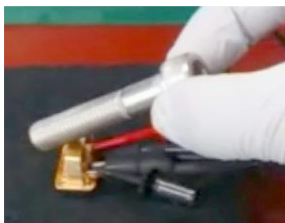
図 3-③-(2)-2.4 ねじ擦りによる連続インパルス加振
