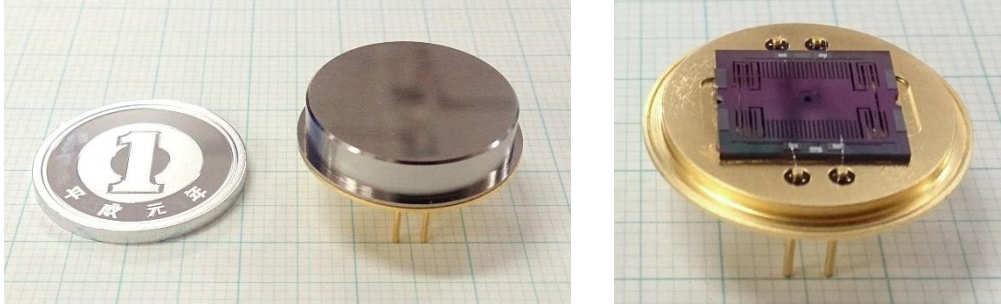
図 3-③-(2)-3.5 インパルス型エネルギーハーベスタ（段付き）試作品
