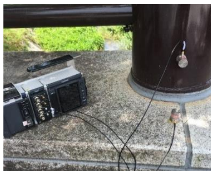
写真3-④-(1)-3.5 橋梁の外観およびセンサ設置状況（宮ノ前橋）
