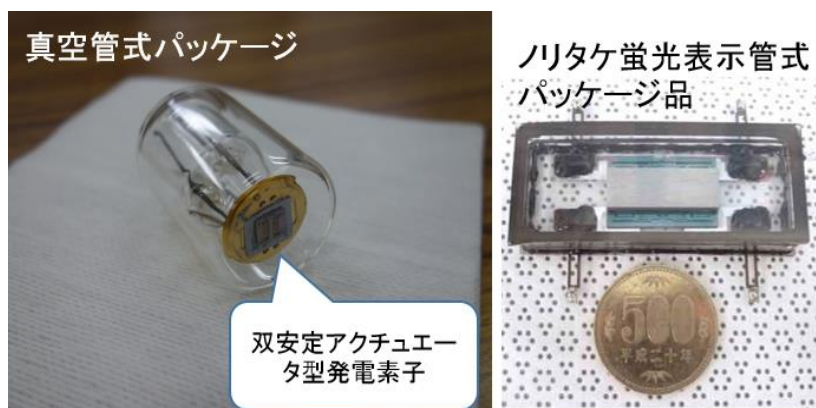
図 3-①-(2)-3.1 試作した高真空パッケージ 左：真空管式、右：蛍光表示管式
