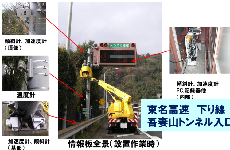
(情報板の振動・傾斜予備計測)
