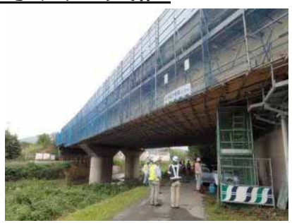
高速道路橋梁の床版にAEセンサを設置し、データを収集
