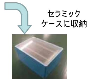
傾斜マルチセンサ端末外観 (寸法70×100×50mm)
