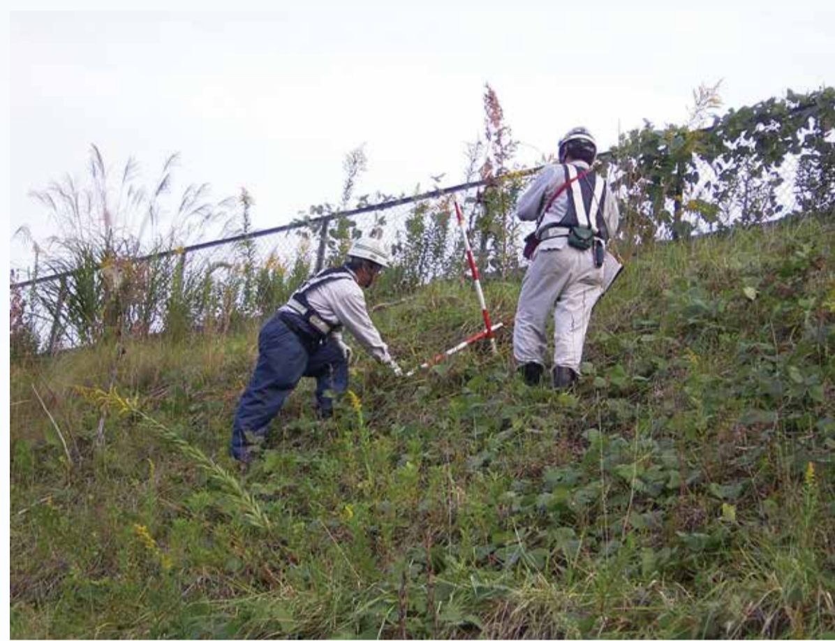
のり面勾配の調査
