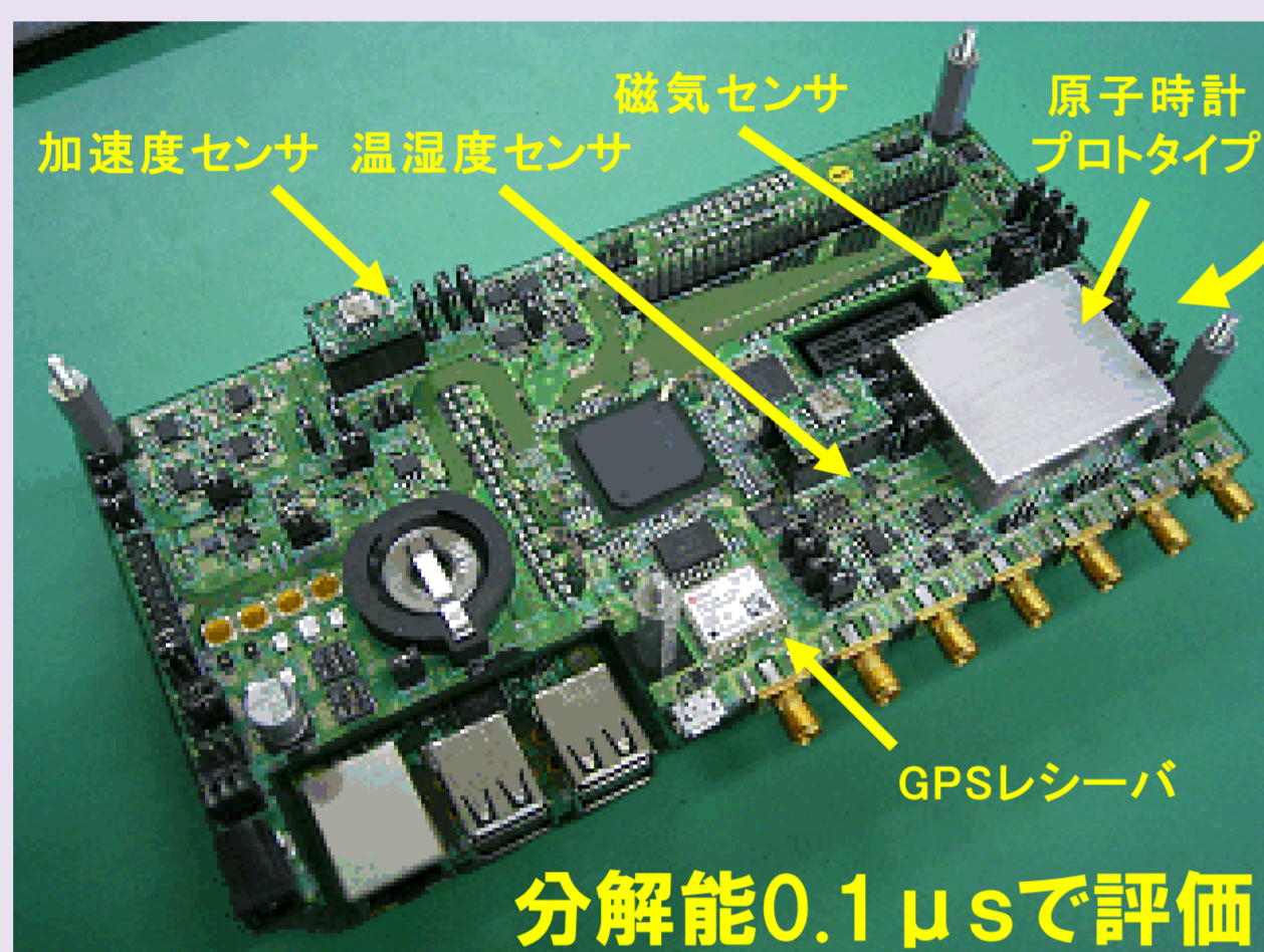
分解能0.1μsで評価 GPS (1PPS) 基準の原子時計評価装置
