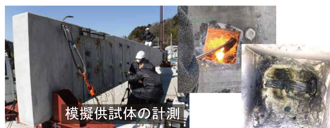
模擬供試体を用いたPC破断試験
