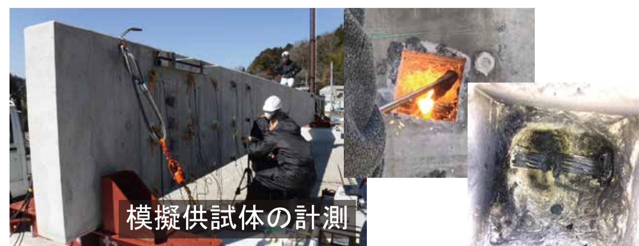
模擬供試体を用いたPC破断試験
