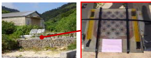
高温多湿・高塩分の腐食促進環境暴露試験
