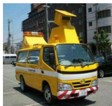
点検車によるモニタリング
