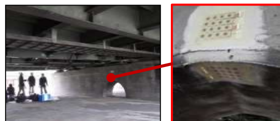
高架橋実証試験(コンクリート橋脚貼付)
