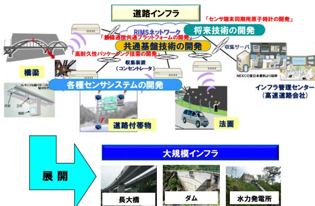
図 1 道路インフラモニタリングシステム (RIMS)
