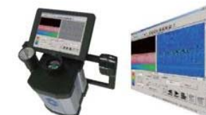
赤外線サーモグラフィ
