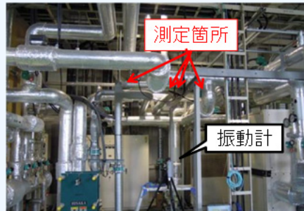
検討①: 実験用設備で冷却水流量と振動の関係を実測
